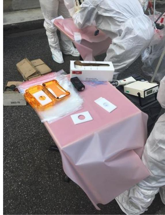
**Figure 5. Zone de réalisation des frottis, avec cale afin de garantir une mesure reproductible.**
