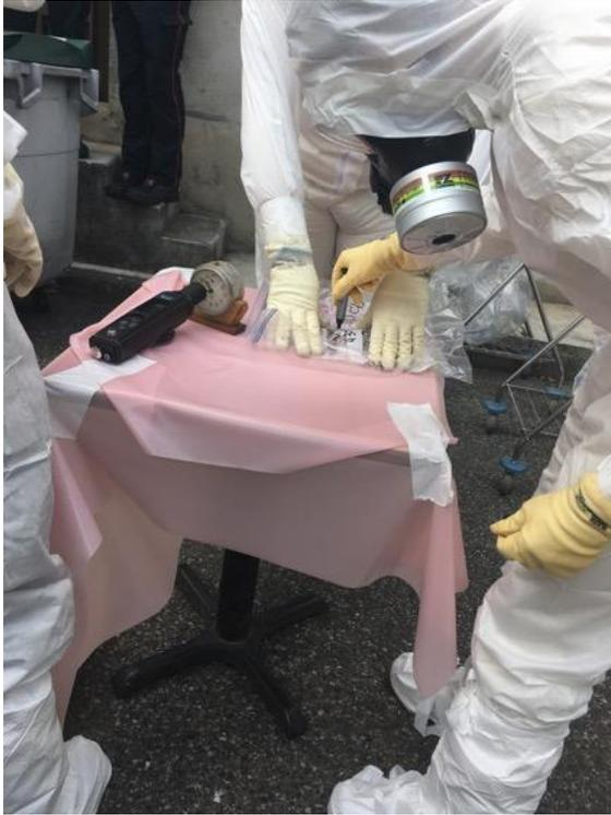
**Figure 3. Réalisation d'une identification au spectromètre gamma.**
